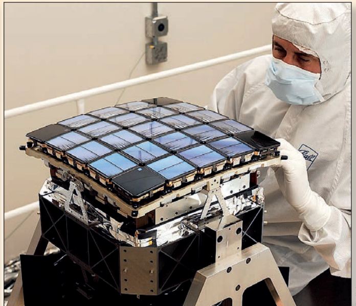
▲ Главное зеркало и блок светочувствительных ПЗС-матриц в сборочном цеху Ball Aerospace & Technologies Corp.
