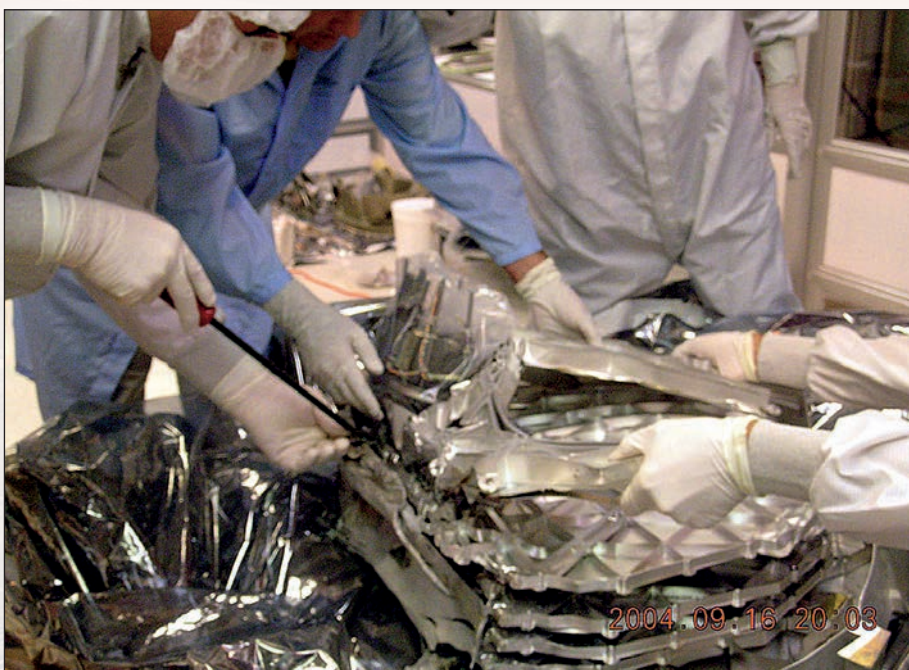
Извлечение коллекторных решеток из покоруженного корпуса.
